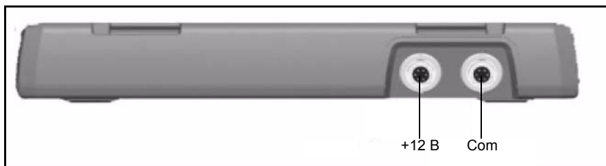
Рисунок 3.6 Стыковочная станция с питанием +12 В и com-портами
