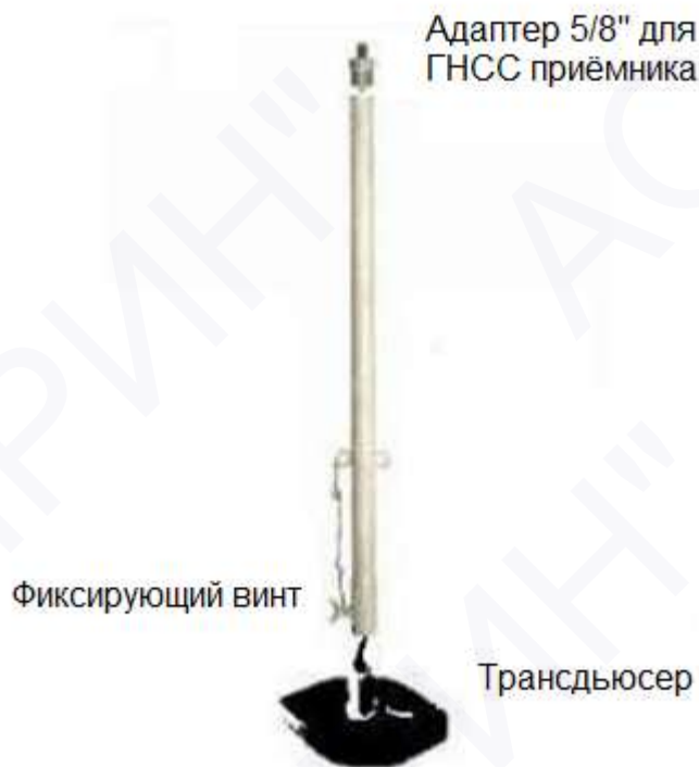
Рис. 2.4 Монтаж оборудования на вехе
